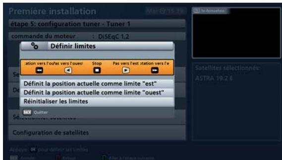
Les touches suivantes permettent de commander les déplacements du positionneur :
